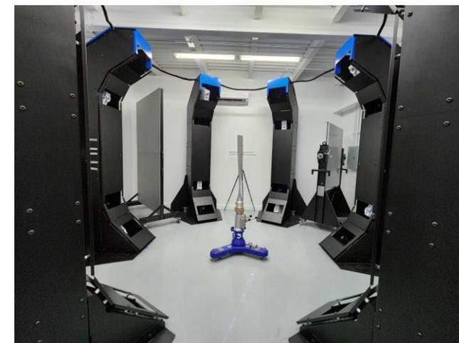
Il Polyrix è un sistema di misurazione tridimensionale ottica avanzato che combina l'acquisizione simultanea da più angolazioni con la capacità di riproiettare informazioni critiche direttamente sul pezzo, migliorando notevolmente l'efficienza e l'accuratezza nei processi di controllo qualità.
