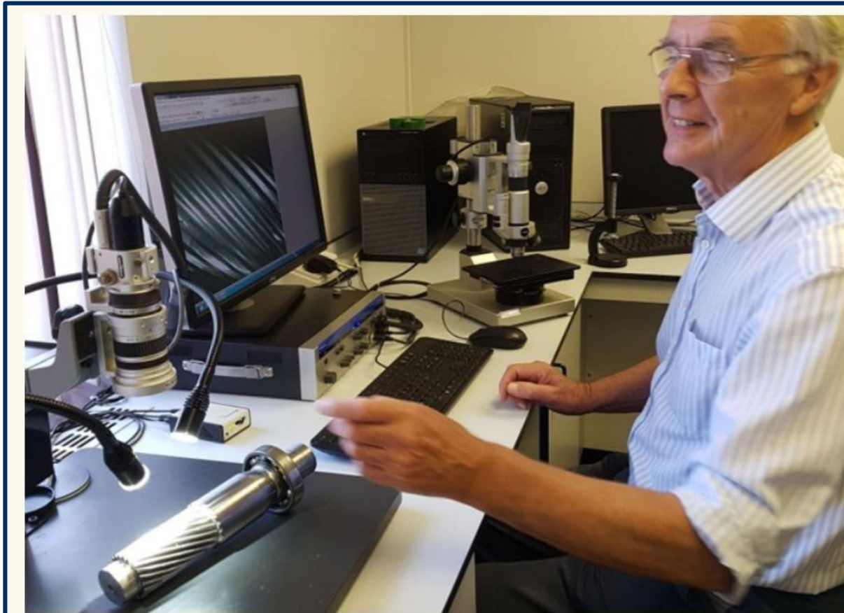
Ingegneria dei metalli – ottica macro per ispezione della finitura superficiale, misura dimensionale e failure analysis di componenti meccanici.
